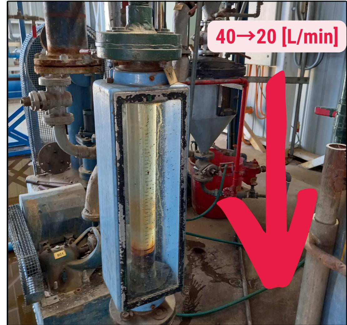
Luego, repetir pero disminuyendo el caudal con mediciones cada 1 [L/min] hasta que el rotámetro marque 20 [L/min]
