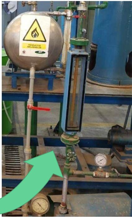
➤ A partir de este momento se debe manipular la válvula V17 para controlar la diferencia de temperaturas en el tren de condensadores.
